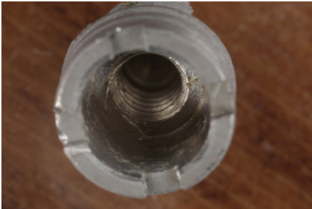
Figura 4. Linha de fratura radial em implante curto devido a torque excessivo durante colocação do cicatrizador.
